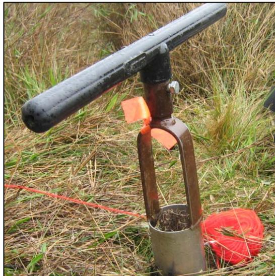
**Figura 18:** Herramientas utilizadas en el muestreo (Barreno)
