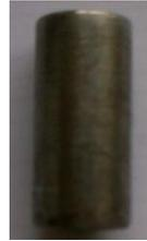
**Figura 2.** Pin de acople para el dispositivo de liberación de masa.
