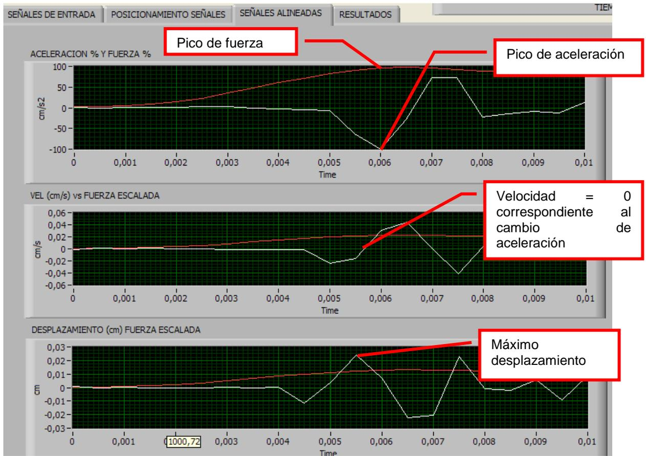
Figura 25. Posicionamiento de las señales
