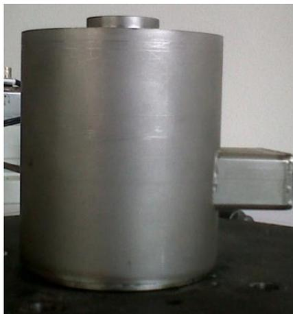
**Figura 9.** Celda de Carga
