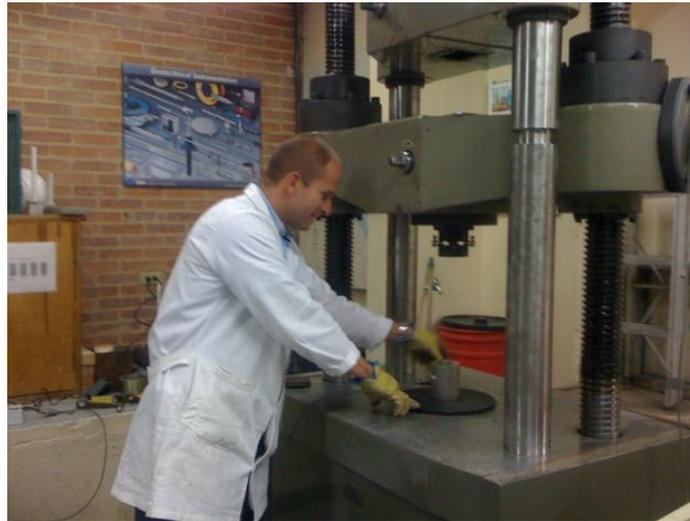
**Figura 16.** Imagen tomada durante el proceso de montaje de la celda de carga en los laboratorios de la U Javeriana. La maquina empleada para la calibración fue la Universal mostrada en la imagen
