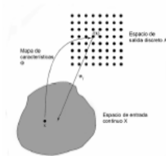
Figura 3. Relación entre el mapa de características y el vector de pesos sinápticos [13]
