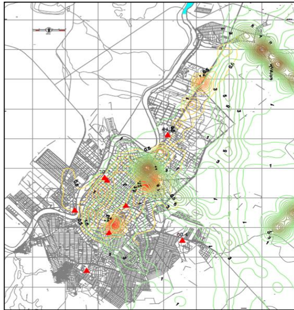
Figura 17. Curvas isopletas de modelo de fuentes fijas (verde) y modelo fuentes móviles (rojas) Fuente: k2 Ingeniería
