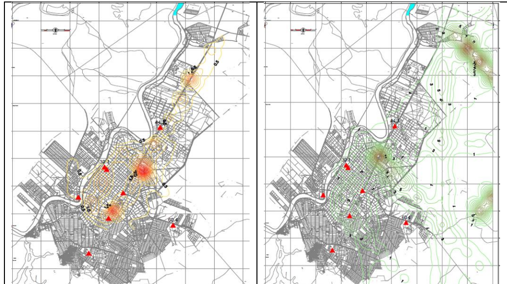
Figura 16. Resultados de modelo de PM10 fuentes móviles (Izquierda) y fuentes fijas (derecha) Fuente: K2, 2007.
