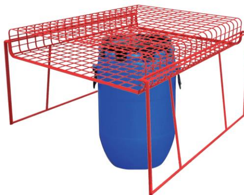
Ilustración 29: Montaje metálico propuesto para la verificación de tamaño de grano (Autor, 2014)
