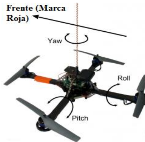
Fig. 1. Descripción de los ángulos fundamentales del Quadrotor AscTech Hummingbird (Ascending Technologies, 2014)
