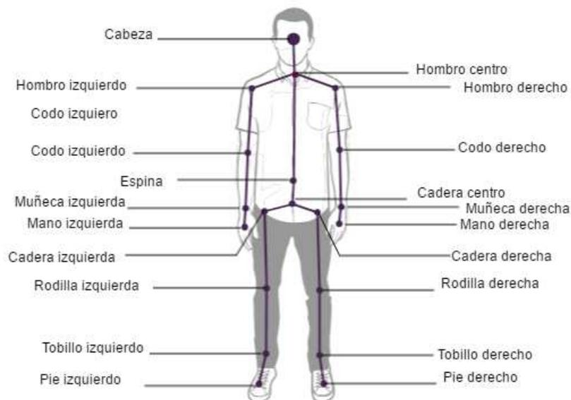
**Figura 7. Esqueleto detectado por Kinect.** Recuperado de <https://msdn.microsoft.com/es-co/library/hh973074.aspx>
