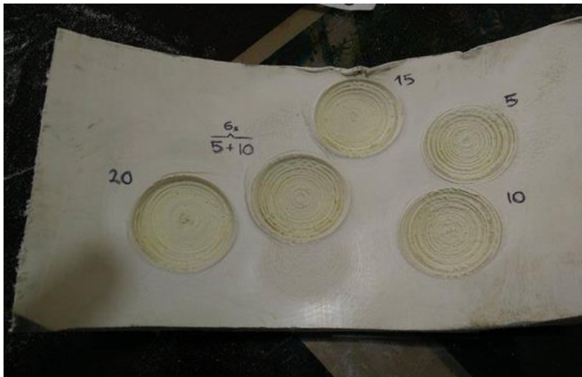
Figura 24: Resultados de prueba de fuerza sobre tubo de PVC.
