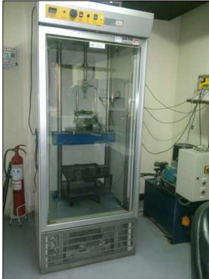
Figura 30 - Equipo NAT para ensayo de módulo resiliente (Imagen tomada del laboratorio de pavimentos de la Pontificia Universidad Javeriana)
