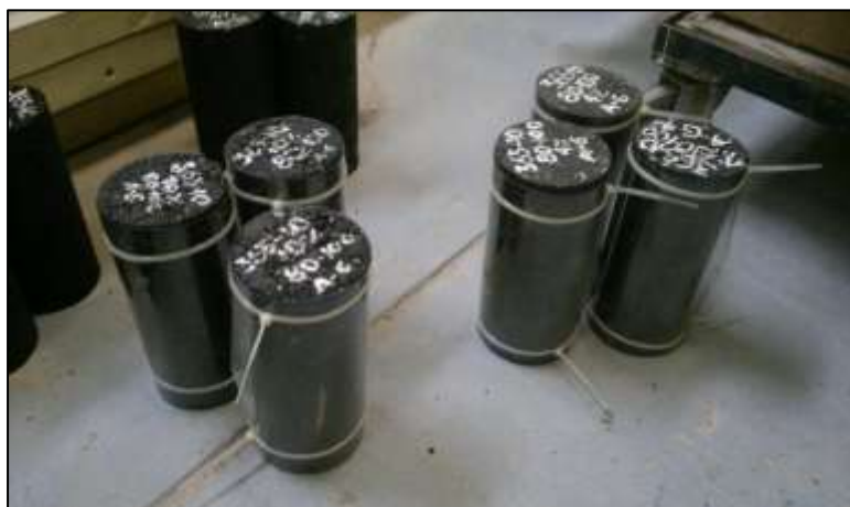
Figura 26 - Briquetas para ensayo de módulo dinámico (10cm x20 cm). (Fuente: Presentación propia de los Autores)
