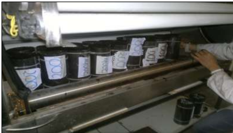
Figura 28 - Briquetas en la cámara ultravioleta. (Fuente: Presentación propia de los Autores)
