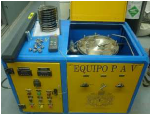
Figura 19 - Equipo PAV. (Imagen tomada del laboratorio de pavimentos de la pontificia universidad javeriana)
