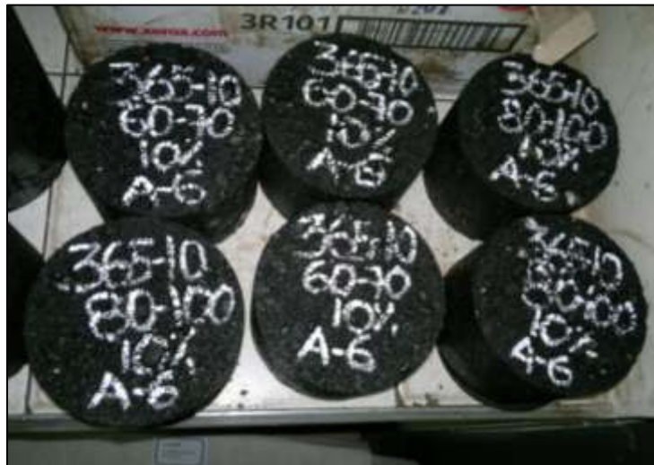
Figura 27 -Briquetas para ensayo de módulo resiliente (10cm x7 cm). (Fuente: Presentación propia de los Autores).
