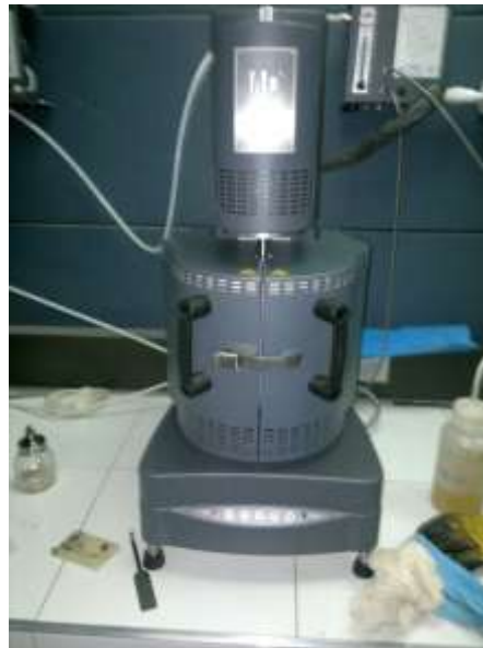
Figura 21 - Equipo DSR (Imagen tomada del laboratorio de pavimentos de la pontificia universidad javeriana)
