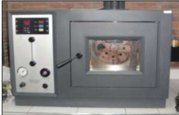
Figura 17 - Horno Rotatorio de Película Delgada. (Fuente: Imagen tomada del laboratorio de pavimentos de la pontificia universidad javeriana)
