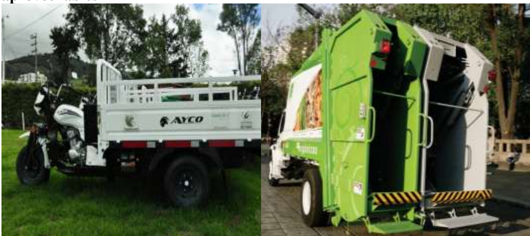
Imagen 1. Motocarro para la recolección de residuos aprovechables Imagen 2. Vehículo para el transporte de residuos orgánicos y la fracción residual.
