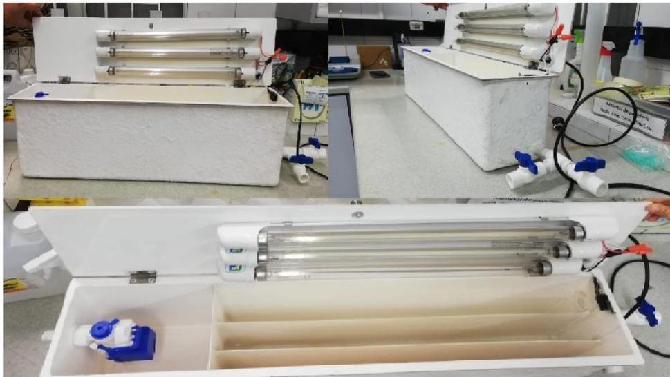
**Figura 3.** Reactor piloto portátil construido por CAMOCOL S.A.S para la instalación en campo.
