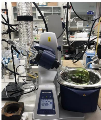
Figura 14. Secado del extracto en evaporador rotatorio.
