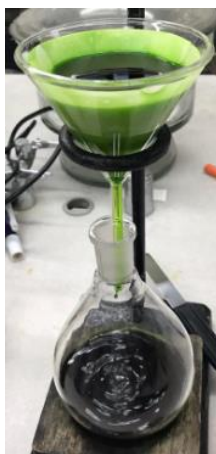
Figura 13. Filtración del líquido extractor transcurrido 72 horas.
