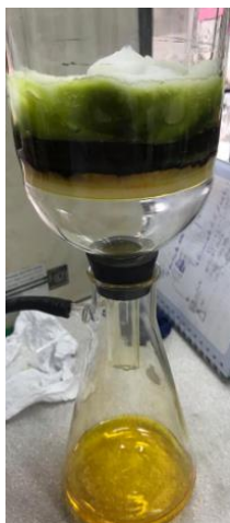
Figura 15. Fraccionamiento del extracto etanólico por cromatografía líquida al vacío.
