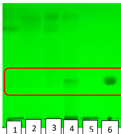
Figura 26. Perfil cromatográfico para alcaloides de extracto y fracciones obtenidas de hojas de A. muricata en sistema de solventes, Tolueno- acetato de etilo- dietilamina (70:20:10) visto a 254nm. Los puntos de siembra corresponden a: (1) Extracto total, (2) DCM 1, (3) DCM 2, (4) AcOEt, (5) hidroalcohólico, (6) cafeína.
