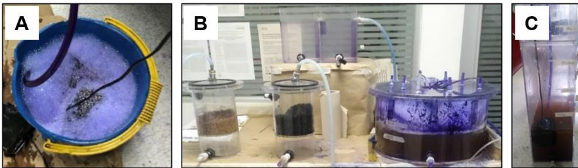
Figura 7. Planta piloto a escala de Laboratorio. Operación unitaria: tanque de igualación (A). De izquierda a derecha, 2 operaciones unitarias: trampa de grasas y filtros de arena cuarcítica y carbón activado, y el reactor biológico que corresponde a un proceso unitario (B). Operación unitaria: sedimentador (C) [Pedroza-Camacho et al., 2018].
