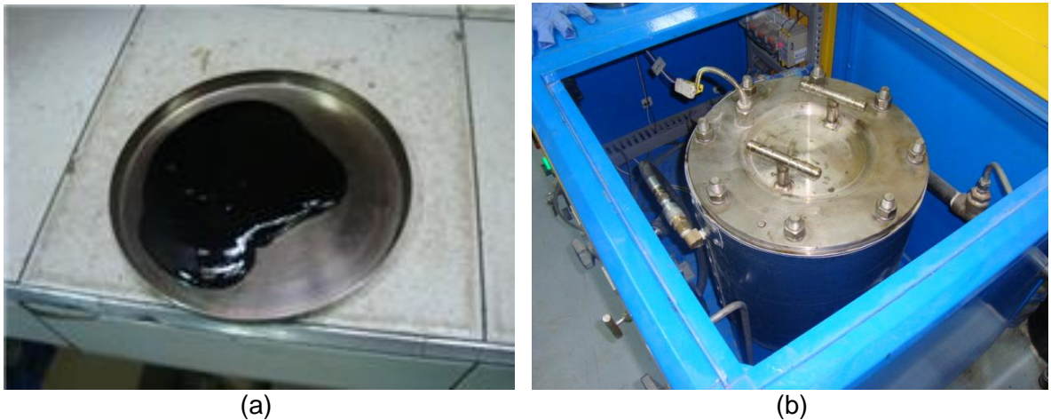
Fotografía 12. Acondicionamiento de cemento asfáltico en Cámara de Envejecimiento a Presión (PAV), (a) bandejas con muestra, (b) Equipo PAV
